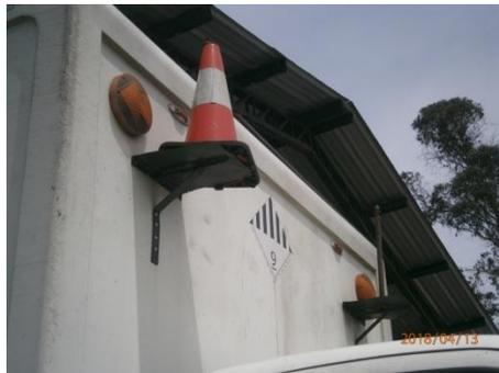
En cuanto a la verificación de los demás implementos de seguridad, se constató que el camión cuenta con la señalética correspondiente (rombo y tarjeta de seguridad), conforme se observa en la Figura 5.
