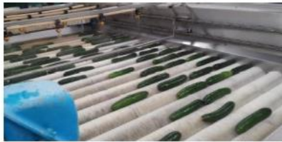
Figura 1. Lavado de fruta. Sistema de aspersión de agua.
