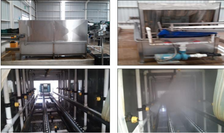
Sistema de lavado de contenedores de plástico.
