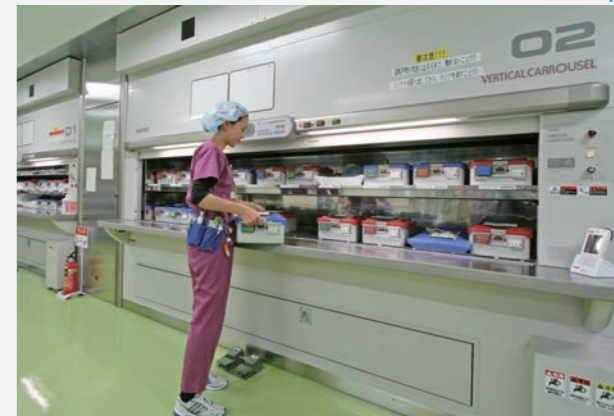
医院专用的系统解决方案 将自动仓库、垂直旋转货柜和无人搬运车有机组合，实现手术器材的保管、供给和回收的全程自动化，大幅节省了院内空间。
