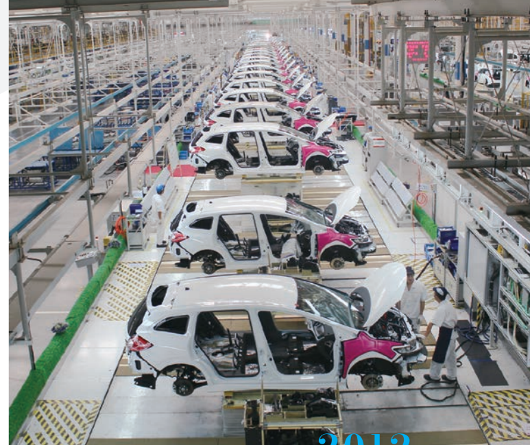
用于汽车总装生产线的输送系统 员工可根据操作需要自由调节生产线上的车身装配高度，实现以人为本的高效率工厂。
