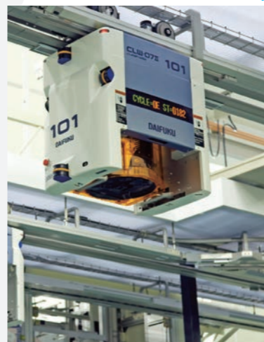
用于半导体生产线的搬运系统 采用最新技术的搬运系统，应对半导体晶片的大型化和细微加工的需求，支持生产线的搭建。
