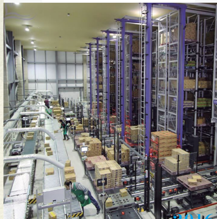
2016年 物流センター 酒類・食品卸業務の自動化を徹底的に追求した最新鋭の物流センター。自動倉庫、高速搬送台車、コンベヤ、仕分けソーターなどの自動化設備で人手不足を解消し物流コストを削減した
