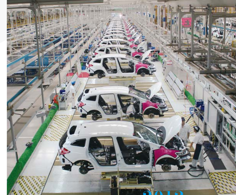
2012年 自動車組立ライン向けシステム 車体の搬送高さを作業者に合わせて自在に設定できる搬送システム。人に優しく高効率な工場を実現
