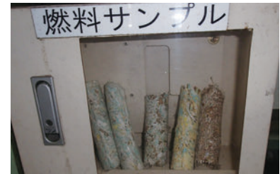
紙系廃棄物を固形燃料にした燃料サンプル
