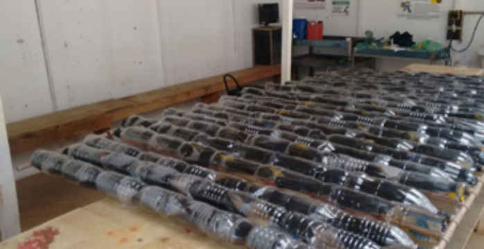
Mais uma inovação ambiental da MBigucci: Painel solar feito com PET's e embalagens de leite, em teste no canteiro de obras do Mundi.
