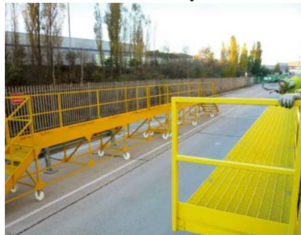
Accès sécurisé sur les camions plateau
