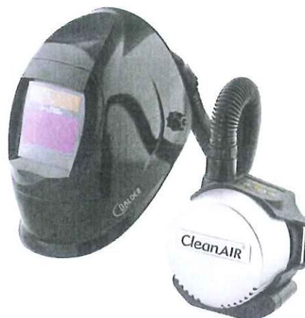
Le moteur CLEAN AIR permet de diffuser un débit d'air compris entre 140 et 210 L/min. Il dispose également d'une alarme, en cas de débit insuffisant et informe l'utilisateur de l'état d'encrassement des filtres et de l'état de charge de la batterie.
