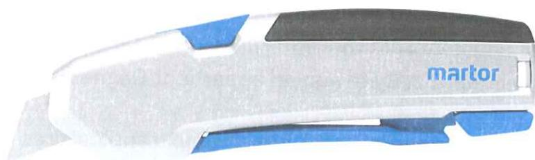
Le MARTOR Secu pro 625 est un couteau de sécurité à gâchette avec rétraction automatique de la lame, qui protège des blessures par coupure. Le tranchant se rétracte automatiquement dans le manche dès qu'il quitte la matière coupée, même avec la gâchette actionnée. De plus, les différents modèles de lames permettent d'élargir les domaines d'utilisation.
