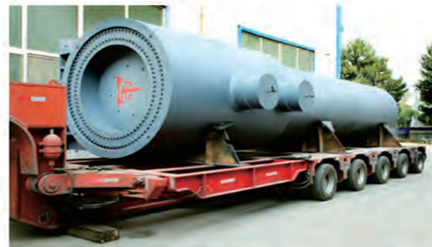
具有优异低温冲击性能的大厚度15CrMoR容器钢板制造的换热器
