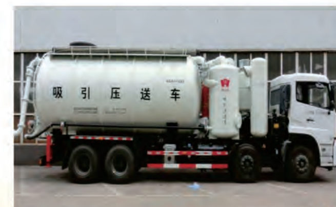
▲ 运输各类除尘灰的吸引压送车
