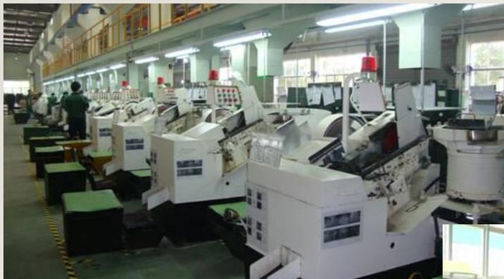
螺栓成型机: 12 台(M5~M12)
