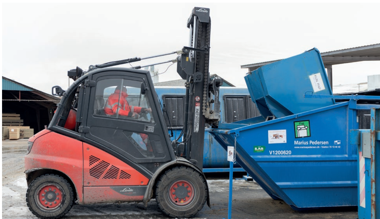
▲ Tømning af vippecontainere sker med truck, så der er minimal manuel håndtering.
