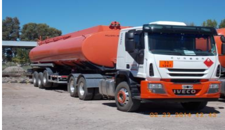
Camión Cargas liquidas de 34 m3
