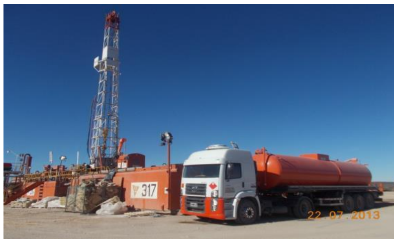
Camión de Vacío de 30 m3 con Bomba s/aceite
