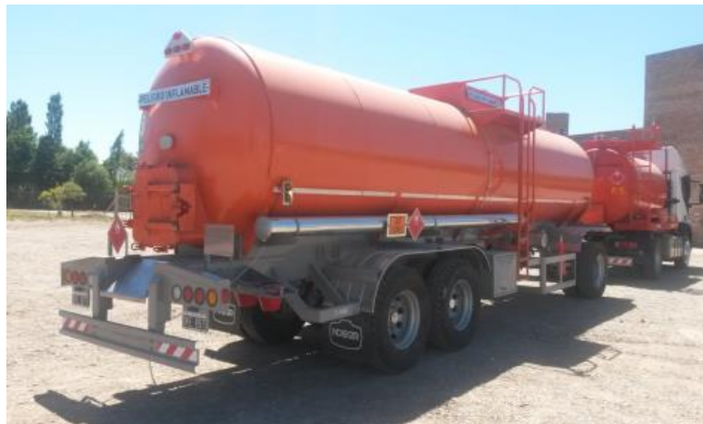
Camión d Vacío de 10 m3 con Acoplado Vacío de 25 m3
