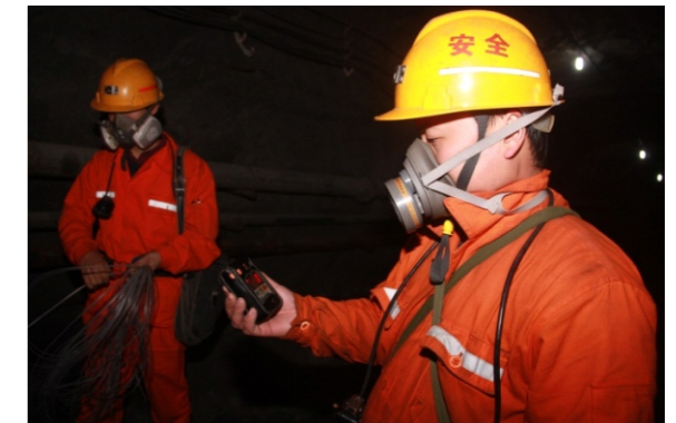
河南金源公司爆破后对有害气体进行现场安全确认
