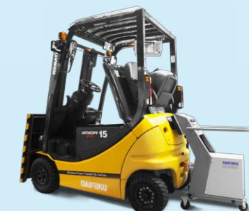
D-PAD 在世界上首次实现电动叉车 非接触式充电系统的实用化
