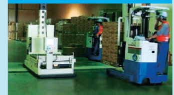
区域管理系统 控制行驶速度达200米/分的高速小车
