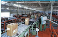
钢带式自动分拣机(Sorting Master) 开发日本国产首款钢带式自动分拣机
