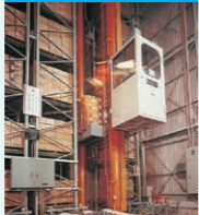
整体式自动仓库系统(Rackbuilt System) 作为适应当时大量消费的革新性 家电自动仓库
