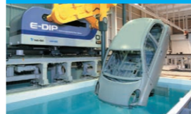
E-DIP 电车输送方式的汽车浸渍涂装系统
