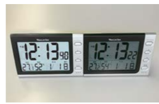
光拡散フィルムを採用したデジタル時計(左)
