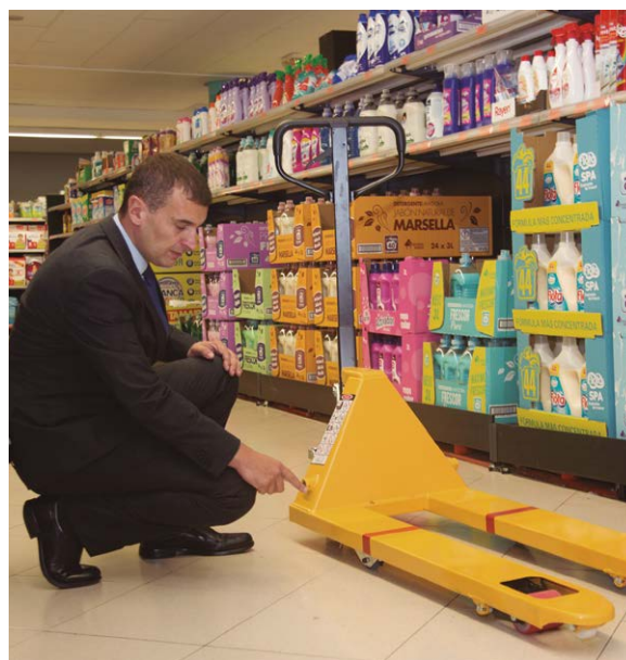
Alberto, responsable de Mantenimiento de Asturias y Galicia, junto a las transpaletas con sistema de muelles de elevación que él ideó, en el supermercado El Fontán en Oviedo.
