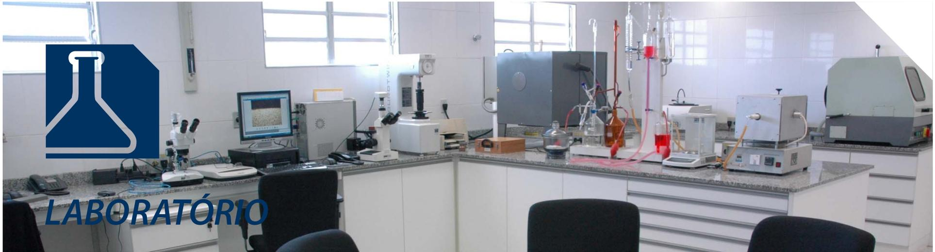
Com laboratório próprio equipado com os mais modernos equipamentos como durômetro, microscópio metalográfico, microscópio estereoscópio, espectrômetro e análises de tração e profissionais especializados, a Açovisa pode realizar diversos ensaios, análises e emitir múltiplas documentações:
