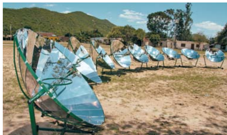
Cocinas solares parabólicas del programa de acceso a la energía, con la ONG EcoAndina, en Salta y Tucumán.
