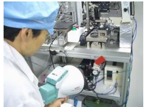
目印がつけられたチェックポイントでエア漏れを測定
