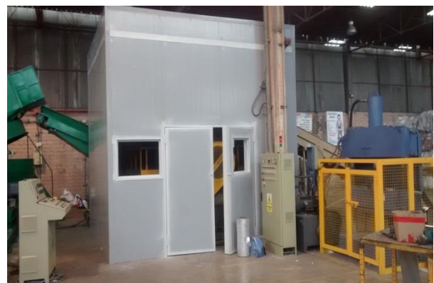
Adicionalmente se instaló una segunda cabina anti sonora con el fin de mitigar el ruido que general el molino de la peletizadora LDR.
