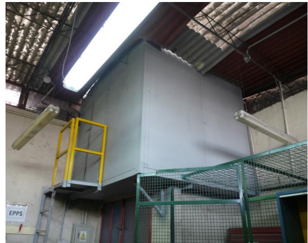
Adicionalmente se instaló una segunda cabina anti sonora con el fin de mitigar el ruido que general el molino de la peletizadora LDR.
