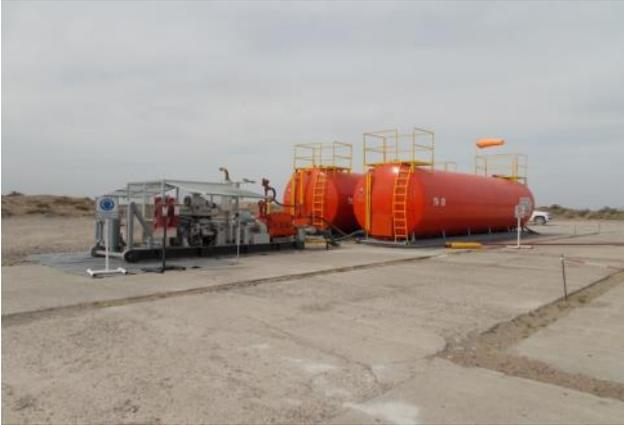
**Bomba Triplex de 1.500 PSI / Tanques de almacenamiento de 70 m3 c/uno**
