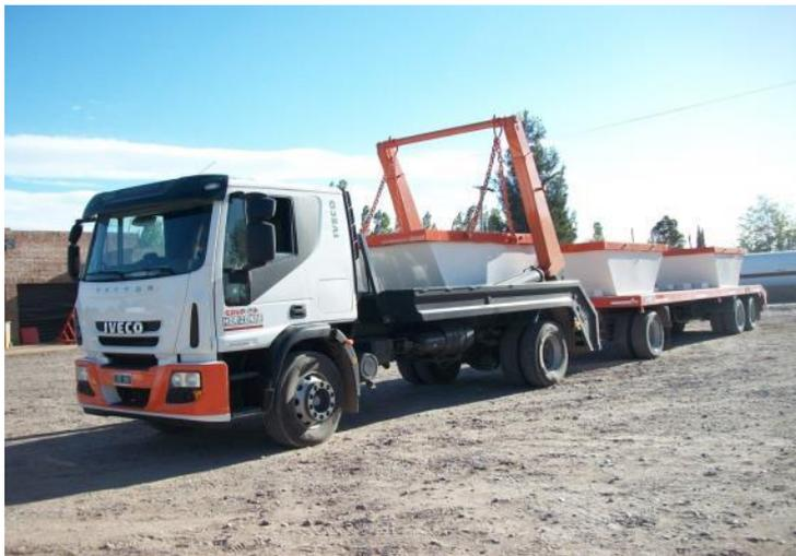
**Camión Porta contenedor Extensible con acoplado**
