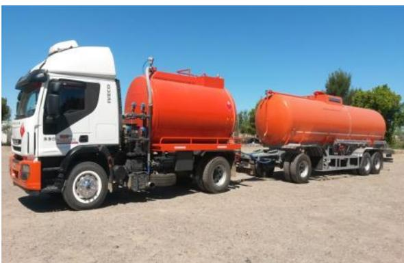
**Camión de Vacío de 10 m3 con Acoplado Vacío de 25 m3**
