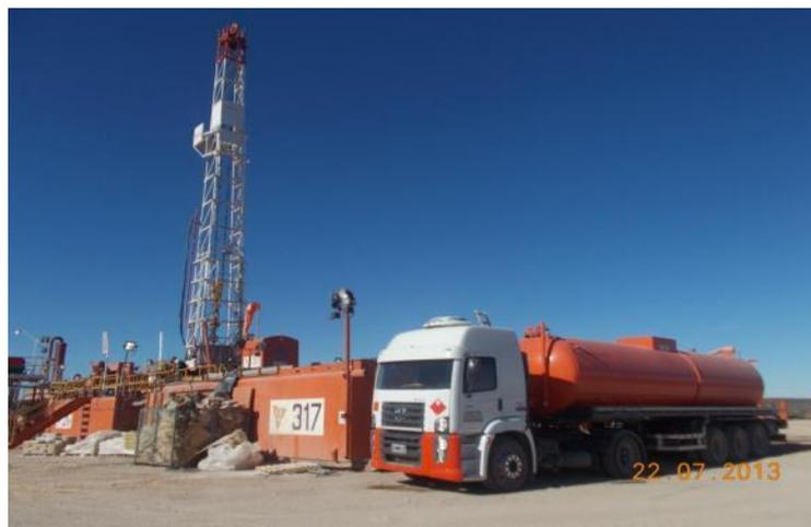
**Camión de Vacío de 30 m3 – Bomba 5009 s/aceite**
