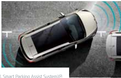
SPAS(주차 조향 보조 시스템, Smart Parking Assist System)은 운전자들의 고민인 주차 문제를 해결해 주는 스마트한 기술이다.
