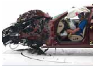
지난 IIHS 평가에서 실시된 스몰오버랩 충돌 테스트 직후의 제네시스 차량의 전면부는 충격이 잘 분산되면서 파손되었지만 운전석은 전혀 손상을 입지 않아 운전자의 안전성이 확보되었음을 입증
