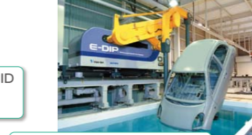
2004年 E-DIP (イーディップ) 電車搬送方式の自動車塗装システム
