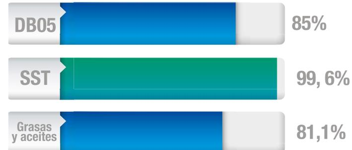
La Empresa lleva varios años trabajando con el sistema de láminas filtrantes para realizar un tratamiento secundario de las aguas residuales industriales, tratadas en la planta de tratamiento. Este es un proceso biológico directamente para hacer la reducción de nutrientes como nitrógeno y fósforo, neutralización de metales pesados e indirectamente para ayudar aún más a reducir la DBO<sub>5</sub> y la DQO.
