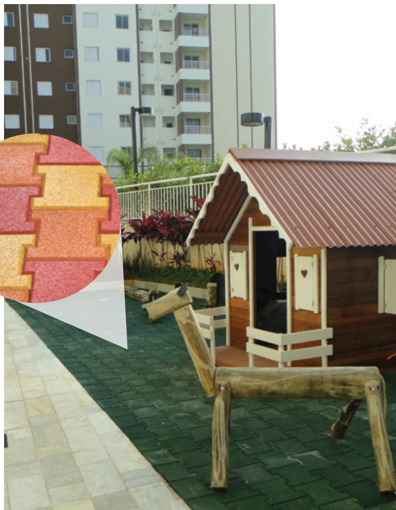
Piso ecológico utilizado no playground do Olímpic MBigucci (Bairro Saúde/SP): além de absorver impacto, cada m 2 retira 4 pneus usados do meio ambiente
