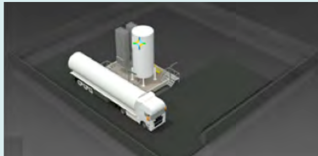
3D View of Modular LNG Plant
