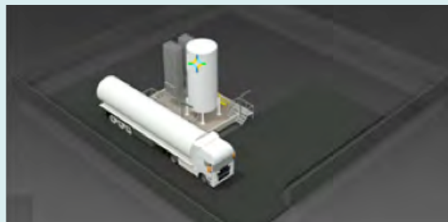
Vista 3D Planta de GNL Modular
