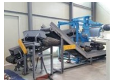
경량가연성 폐기물 선별시스템 Pilot Plant
