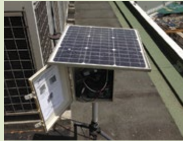
Down Town Line C937현장 : 태양광 발전 소음측정기 운영을 통한 에너지 절감 및 소음민원 저감
