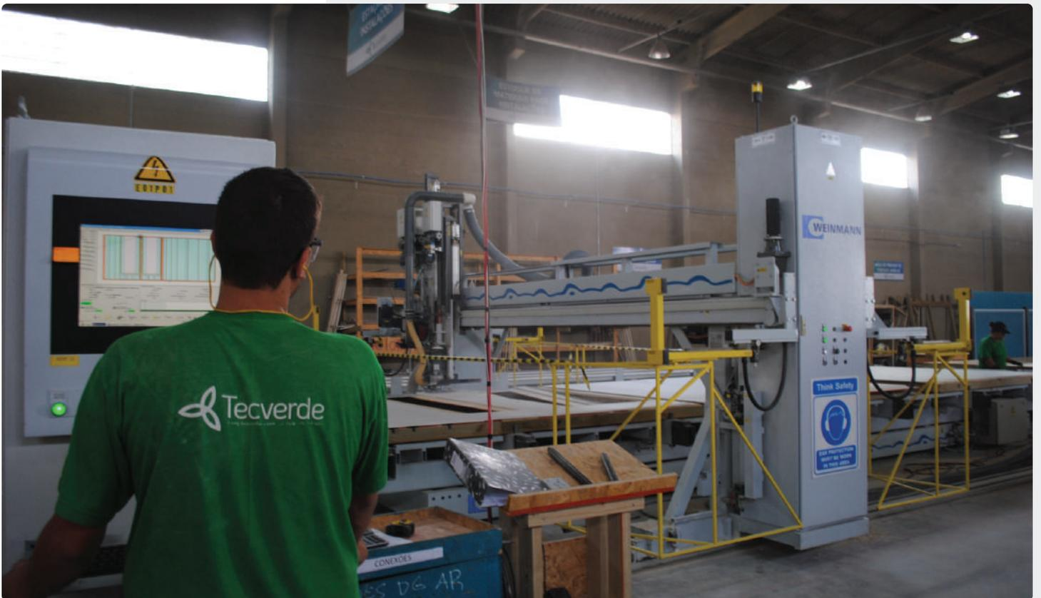
Figura 15: Colaborador operando a ponte multifuncional.
