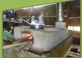
Este tipo de estufa consiste en un bloque de barro, con ductos y agujeros donde se colocan los utensilios para cocinar. Si se utiliza adecuadamente puede ahorrar entre 25% y 50% de la leña que consume un fogón tradicional.
