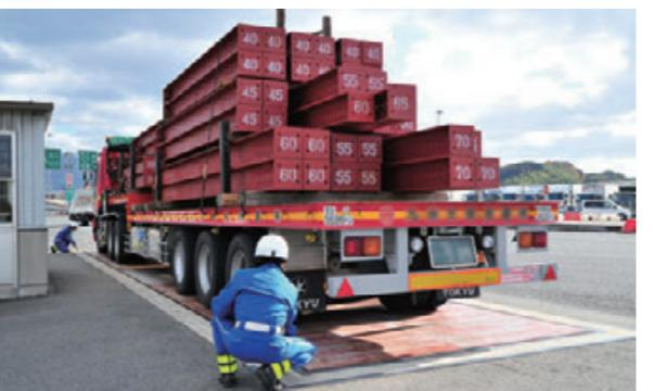
IC等に設置した車重計での積載量制限の取り締まり
