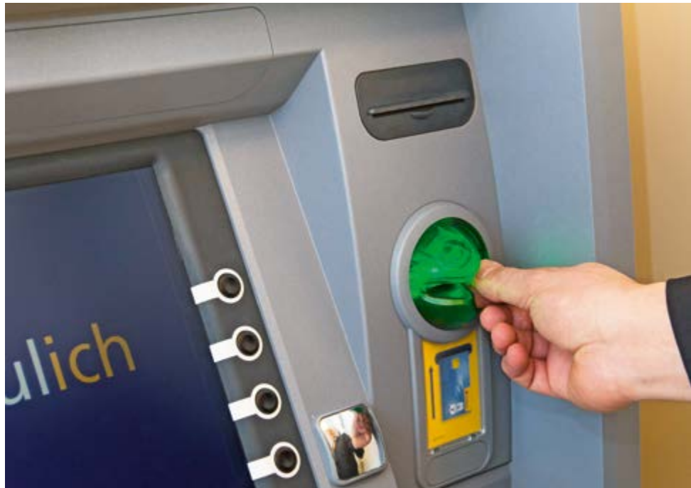
Geldautomat mit einem sogenannten „Froschmaul“ zur Betrugsprävention
