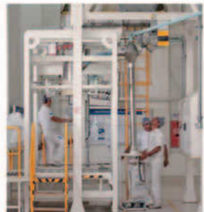
▲ Posquemadores para tratamiento de las emisiones atmosféricas. Colcafé, Bogotá - Colombia.
