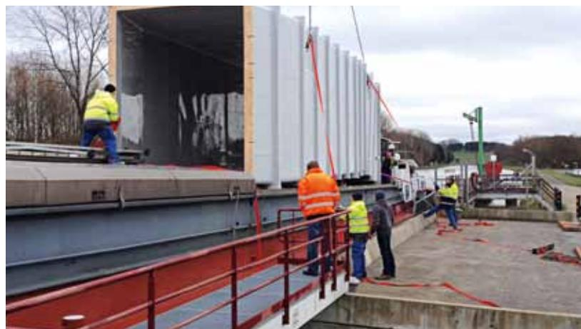
Chargement de gaines en FRP fabriquées par ACS (Belgique) pour un projet au Brésil
