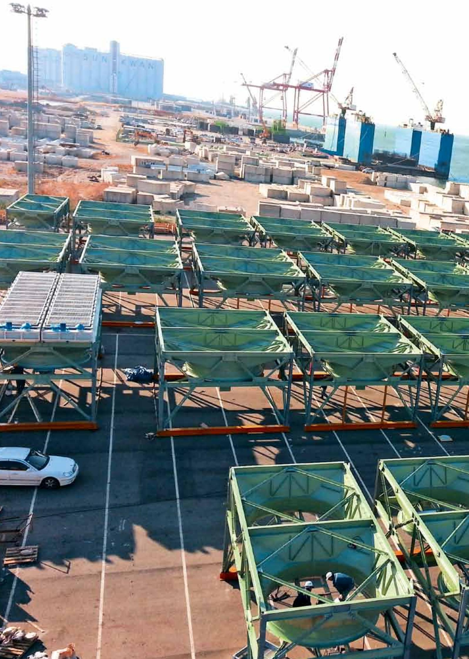
Charpentes d'aéroréfrigérants produites par notre nouvelle usine de Gusan (Corée), avant assemblage des faisceaux de tubes et expédition par bateau
