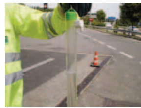
Agu del separador de hidrocarburos después del tratamiento Biothy
