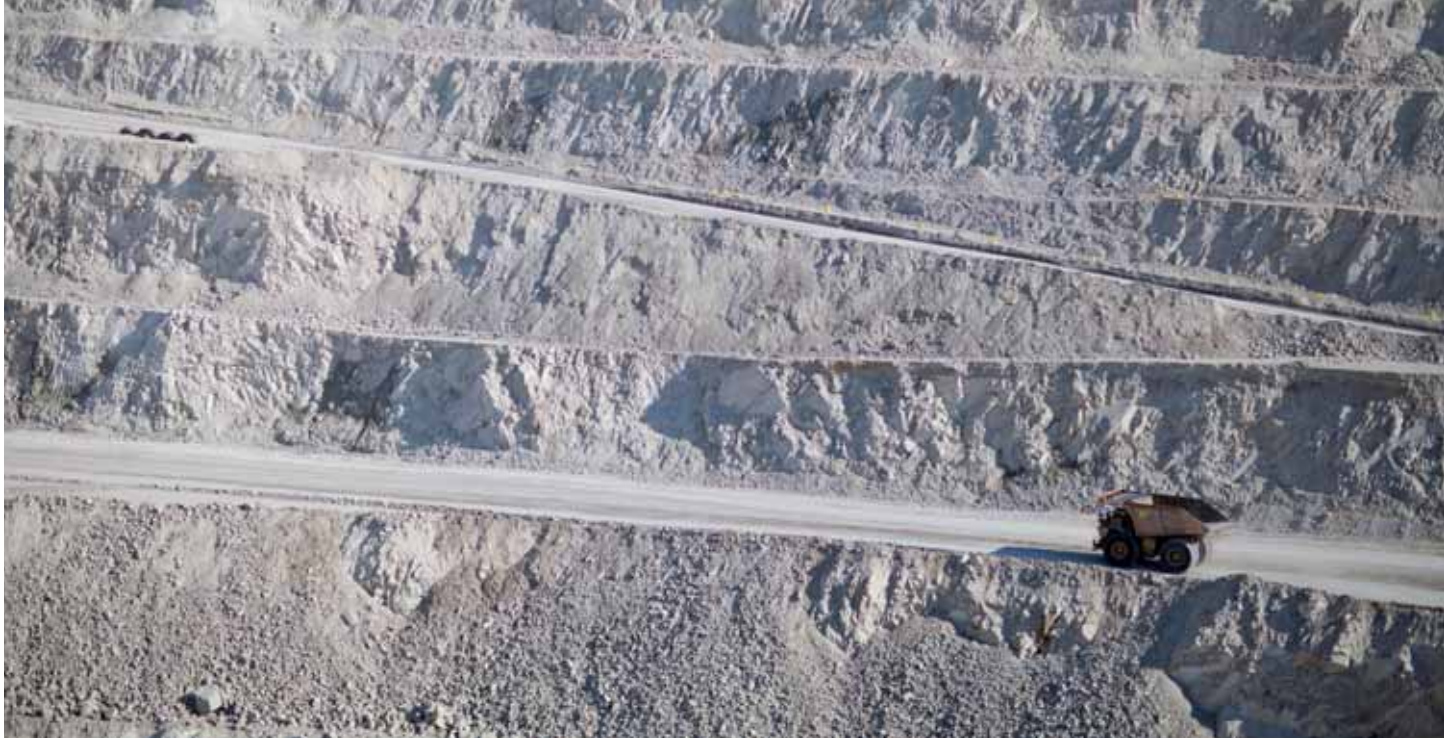
Camino de acarreo en las operaciones Highland Valley Copper en Columbia Británica.
