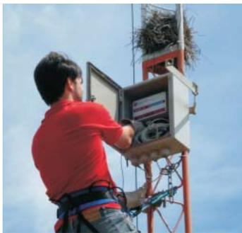
**Detalhe da operação de coleta de informações por técnico da AEBA na torre em cujo topo encontra-se instalado um anemógrafo. Futuramente tal operação será efetuada “on-line”.**
