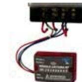
**Vigilante Electrónico.** Equipo que detecta el hurto de cables de energía eléctrica mediante el censado de la tensión de las líneas. Éste actúa mandando un mensaje vía Internet a una central de monitoreo cada vez que detecta que existe una caída de tensión en sus líneas.
