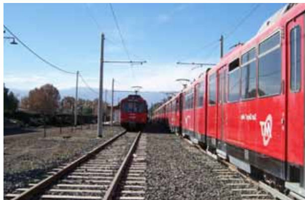
Puesta en marcha de Metro tranvía en la ciudad de Mendoza con vagones Siemens Duewag U2.
