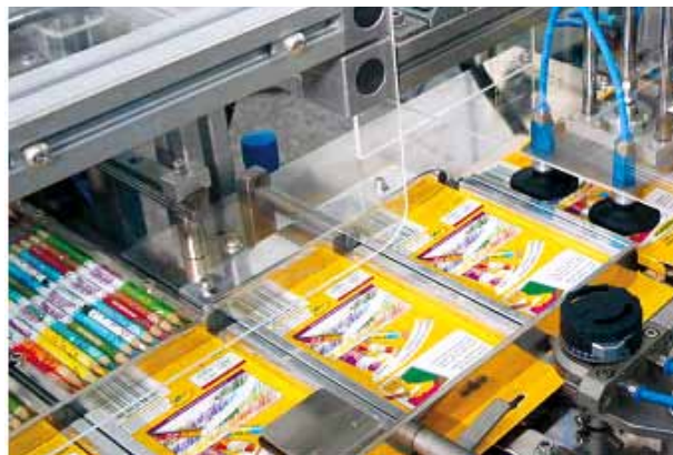
Máquinas estuchadoras con calidad de exportación a nivel mundial controladas a través de un Sistematic S7 1200, ubicadas en Ituzaingó, Provincia de Buenos Aires.
