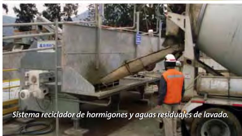
*Sistema reciclador de hormigones y aguas residuales de lavado.*
