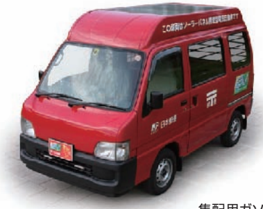
集配用ガソリン車を改造した電気自動車
