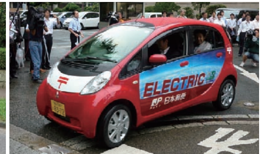
集配用ガソリン車を改造した電気自動車
