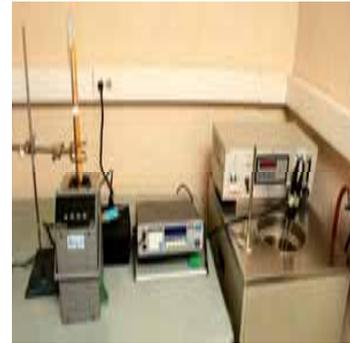
Contamos con medios y patrones de alta calidad con incertidumbres de hasta 0,005°C calibrados por el CENAM para poder cubrir un amplio intervalo de temperatura con excelentes niveles de incertidumbre de hasta 0,020 °C.
