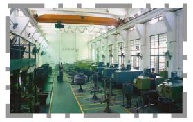
螺栓成型机: 12台 (M5~M12) 全自动分检机: 14 台
