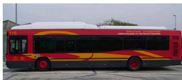
Autobús marca Irisbus propulsado por GNC
