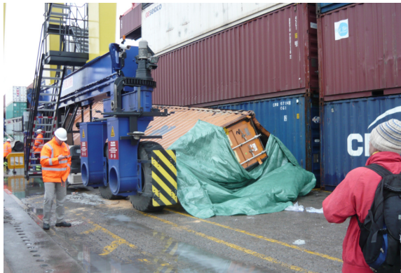
CAIDA DE UN CONTENEDOR CON DERRAME DE P.QUEMICIOS
