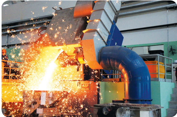
先进的单一电炉（中频炉）熔炼
