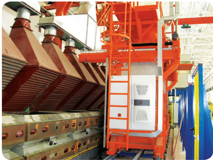
自动浇注机，工人再也不用接触高温铁水包
