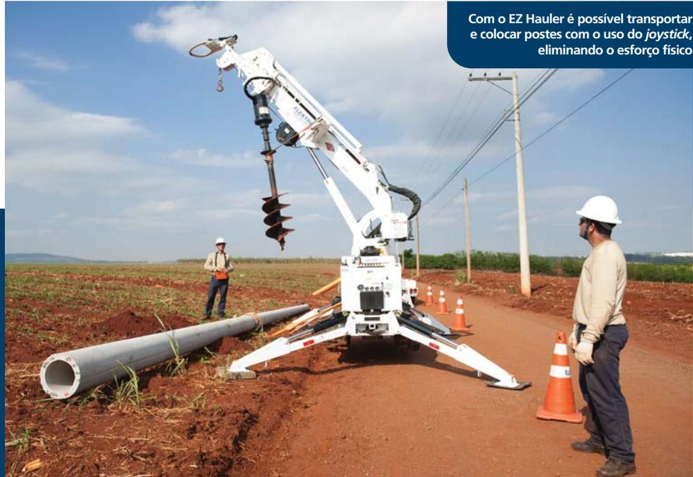
Com o EZ Hauler é possível transportar e colocar postes com o uso do joystick, eliminando o esforço físico
