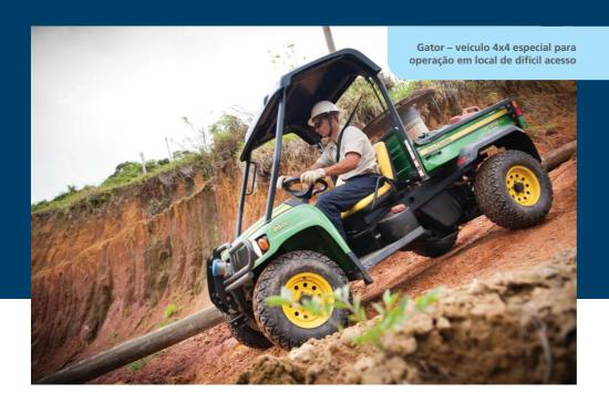
**Gator** – A Elektro mantém três veículos *off road* de pequeno porte para utilização em áreas de difícil acesso. Permite o transporte de transformadores, materiais e postes modulares de fibra de vidro ou aco.
