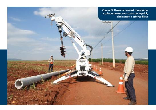
**EZ Hauler** – Veículo dotado de esteiras deslizantes que possibilitam a construção e preservação de redes em locais de difícil acesso. Ideal para transporte e instalação de postes em pontos com vegetação densa, solo arenoso e/ou pantanoso. Além disso, escava o solo por meio de perfuratriz acoplada, evitando o trabalho manual, e é comandado a distância por controle remoto. Pode trabalhar com cesta aérea com isolação de 46 kV. No ano, a Empresa adquiriu dois desses veículos.
