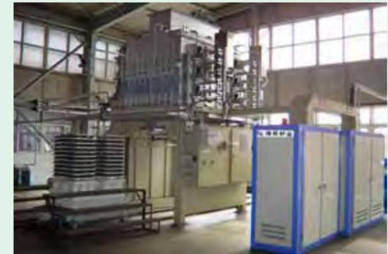
人工智能可控气氛钟罩式系列电阻炉
