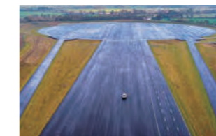
直線1km、直径300mの制御可能通信網を備えた高速限界挙動評価システム
