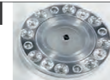
高度なサンプルハンドリングを可能にするリュウグウの試料専用の容器(セル)も開発
